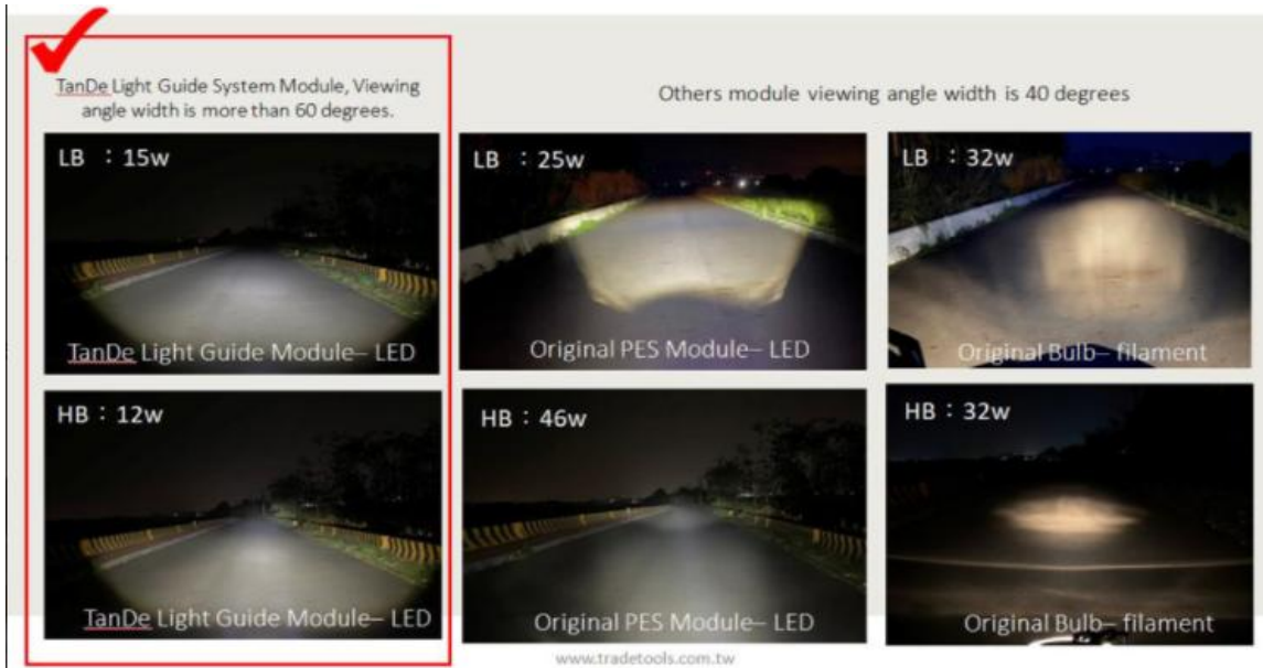
圖六：本公司自行車薄型頭燈光形特性
