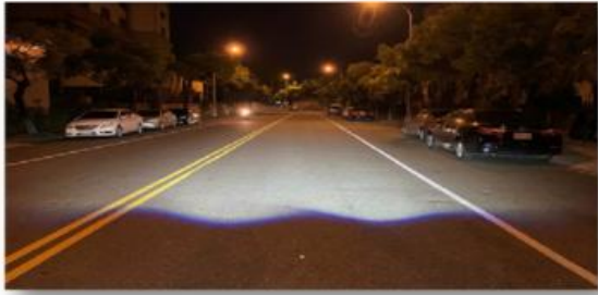
導光式車燈LED燈源模組(右駕)
